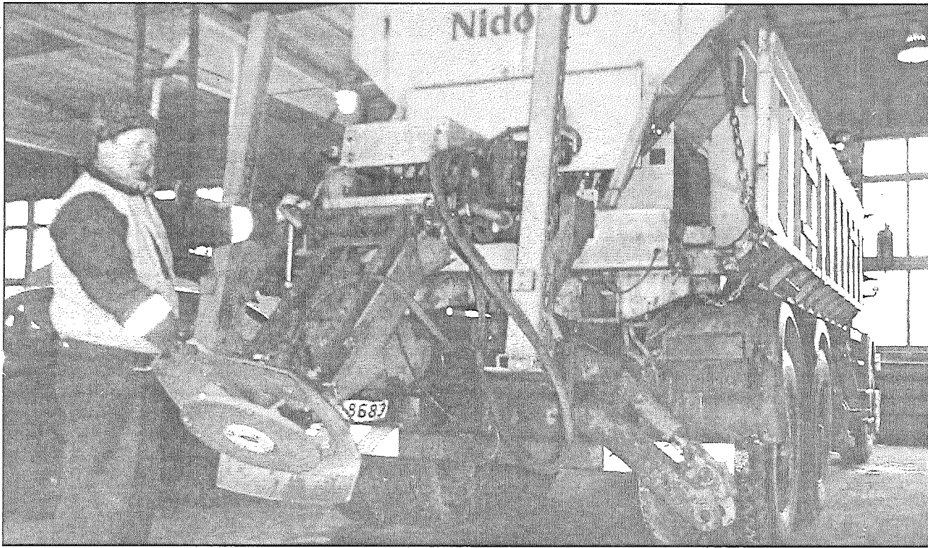
● Akciju sabiedrības «Latgales ceļi» filiāles «Jēkabpils ceļi» pieredzējušais autovadītājs Fjodors Bogdanovs ar SCANIA ir gatavs gan sniegu no ceļiem nošķūrēt, gan ar pretslīdes materiālu nokaisīt. Sešu kubikmetru sāls pietiek, lai novērstu slīdamību uz aptuveni 70 kilometriem ceļa. Foto: M.Rukosuļevs
